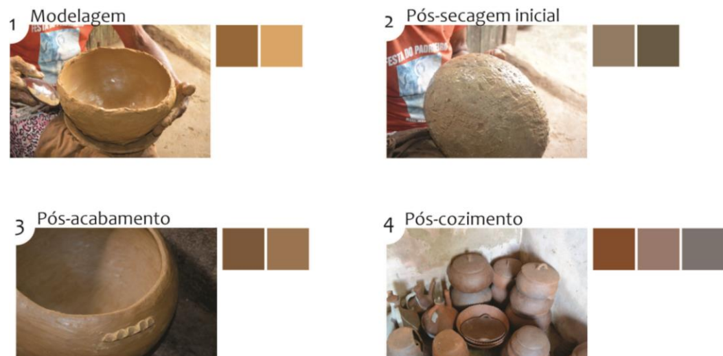
Figura 8 – Gradação das cores no processo de concepção dos artefatos
