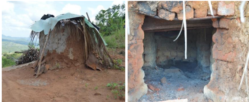
Figura 6 – Forno artesanal para queima das louças de barro
